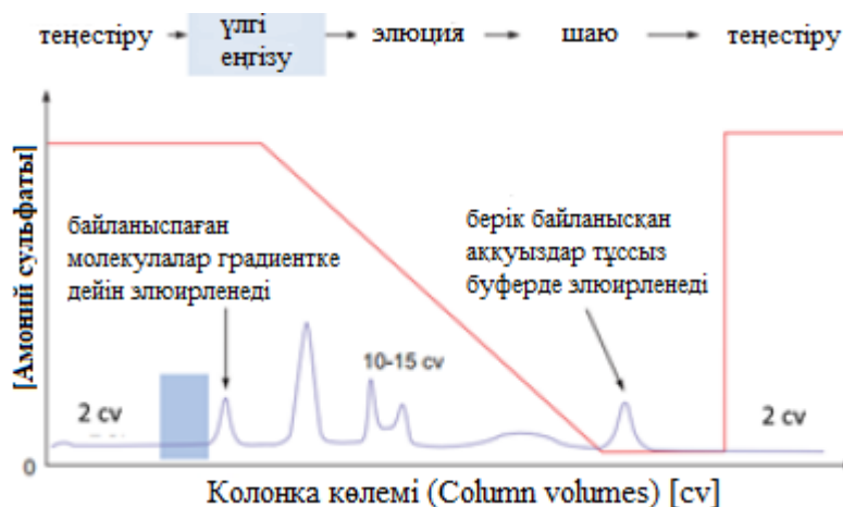
5 сурет- Гидрофобты бөлудің типтік хроматограммасы.
